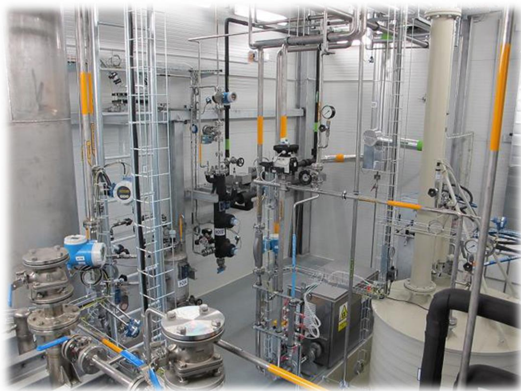
Syntéza F-T se separací produktů
